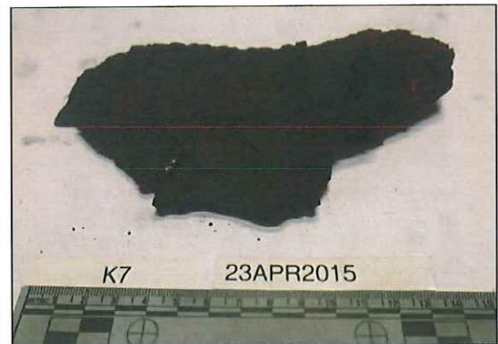
Ilustración 48: Fragmento de neumático de K7.
