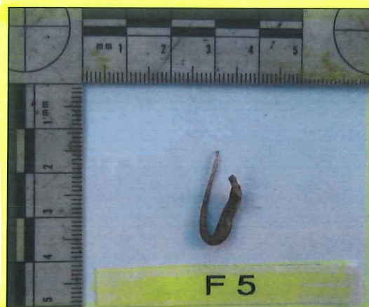
Ilustración 52: fragmento de vidrio con deformación por alteración térmica.
